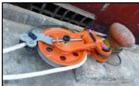
Fig. 47: Efecto polea del sistema shore tensión.
